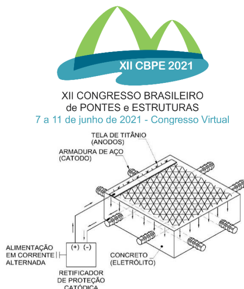
Fig. 6 Esquema Típico de Instalação de um Sistema por Corrente Impressa utilizado na Estátua do Cristo Redentor, no Rio de Janeiro
