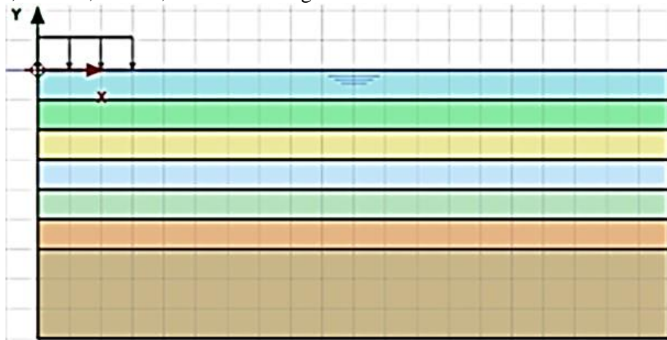
Figura 14 – Tela do PLAXIS – Modelo em solo heterogêneo.
