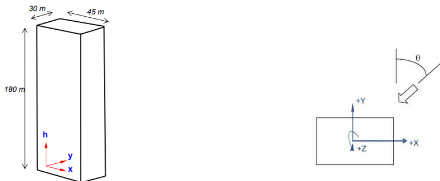
Figura 4 – Geometria do Edifício Básico e direção de incidência do vento (IAWE, 2012a).
