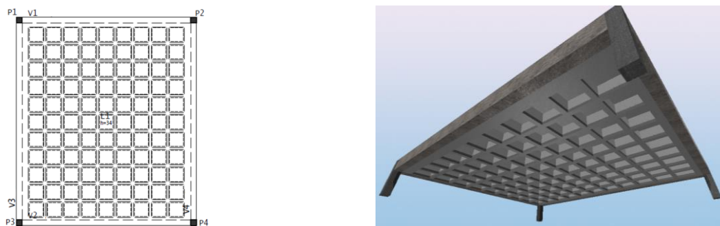
Figura 2 – Modelo da laje isolada nervurada.
