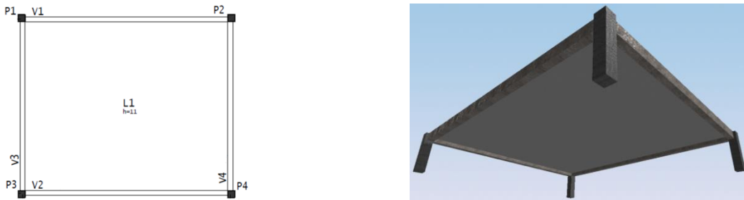
Figura 1 – Modelo da laje isolada maciça.
