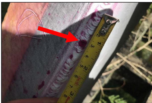
Figura 14 – Ensaio de Líquido Penetrante em solda. Fonte: próprio autor.
