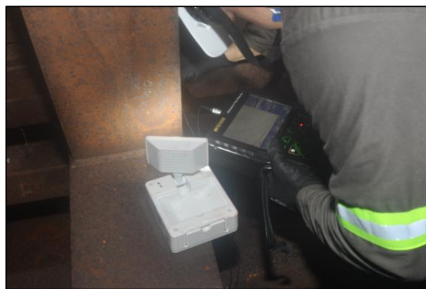
Figura 15 – Ensaio de Ultrassom em solda. Fonte: próprio autor.
