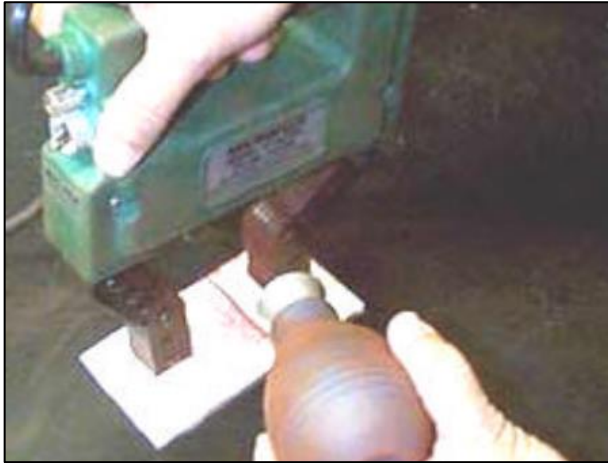
Figura 16 – Ensaio de Partícula Magnética. Fonte: Andreucci (2007).
