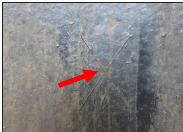
Figura 13 – Ensaio de aderência da película seca. Fonte: próprio autor.
