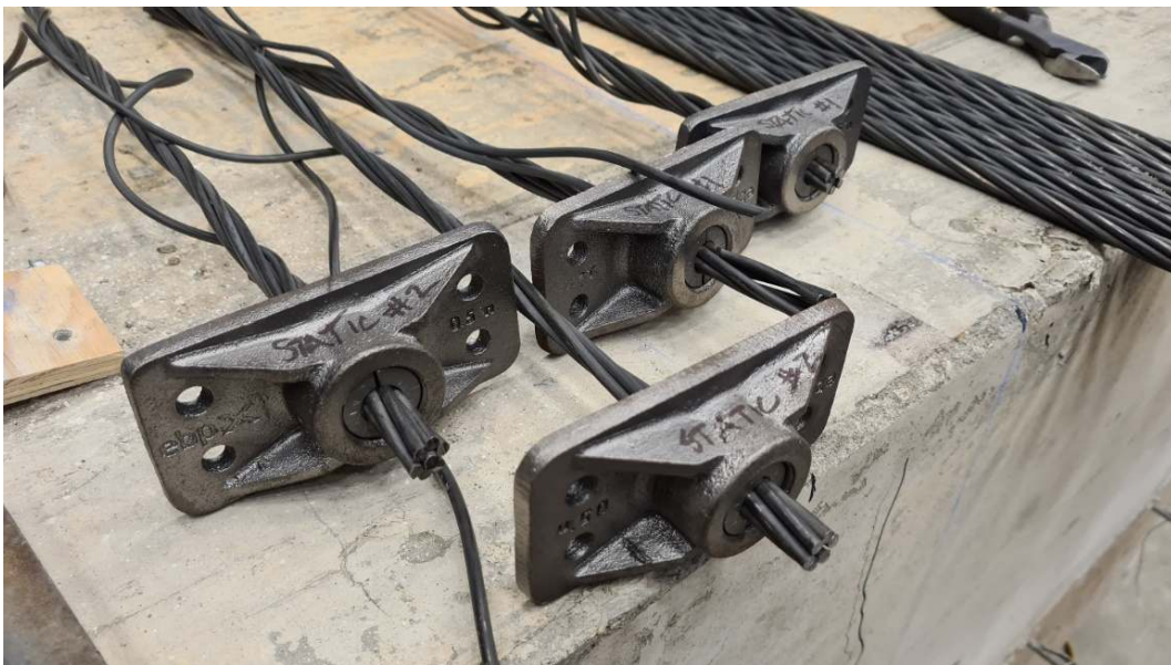
Figura 4 – Placas de ancoragem e cunhas após o ensaio estático
