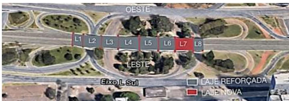
Figura 02 - Mapeamento lajes do Viaduto Eixo Rodoviário Sul, Fonte: Adaptado de Google Earth.
