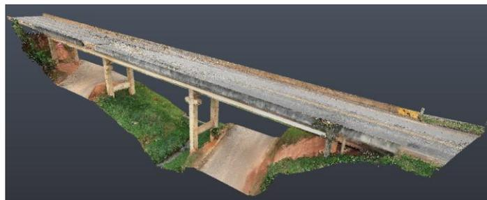
**Figura 10 – Nuvem de pontos filtrada e delimitada no Autodesk ReCap Pro 2023**
