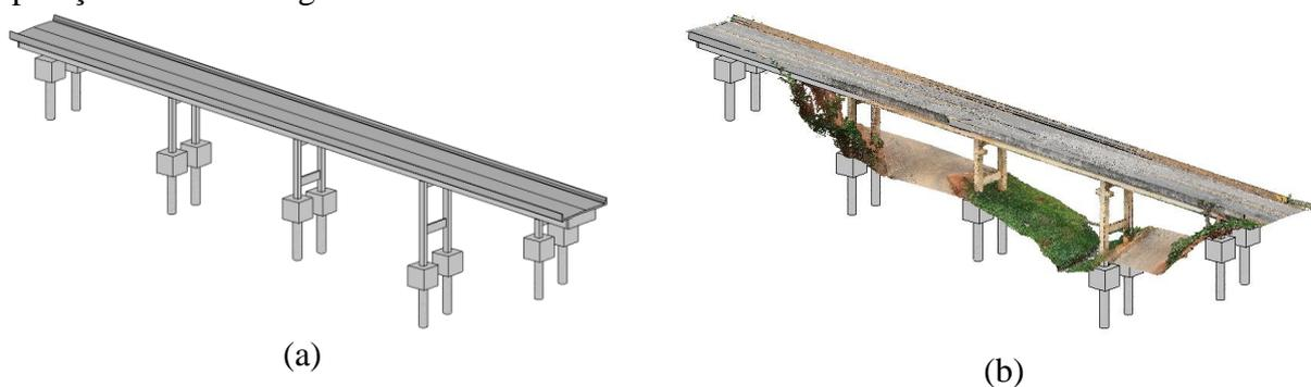
**Figura 12 – (a) Modelo proposto para a ponte; (b) sua sobreposição com a nuvem de pontos**
