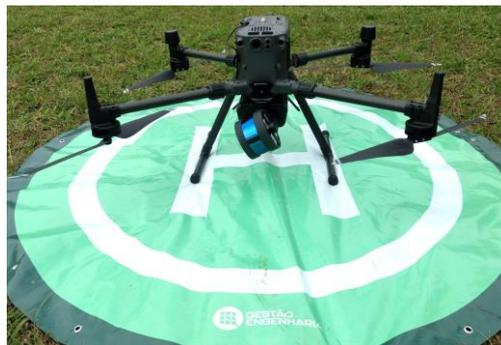
**Figura 9 – Drone DJI Matrice 300 RTK**
