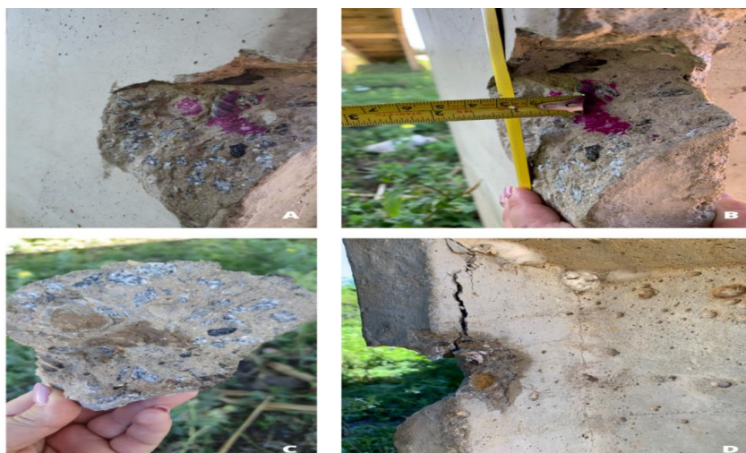
Figura 3 - (A) e (B): Ensaio de carbonatação no P1. (C) e (D): ensaio de cloretos no P1.
