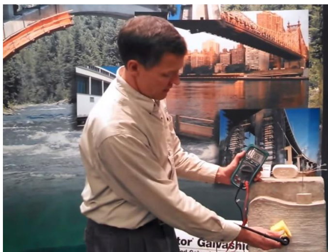
Figura 7. Medições dos potenciais das armaduras em relação ao concreto, com o auxílio de um voltímetro de alta impedância e um eletrodo de referência de Cu/CuSO 4 . De acordo com os resultados consegue-se mapear as regiões de corrosão ativa e definir os locais para a instalação dos anodos galvânicos Galvashield CC, sem a necessidade de quebrar o concreto e expor as ferragens.
