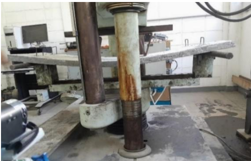
Figura 3 – Execução do ensaio de resistência à tração
