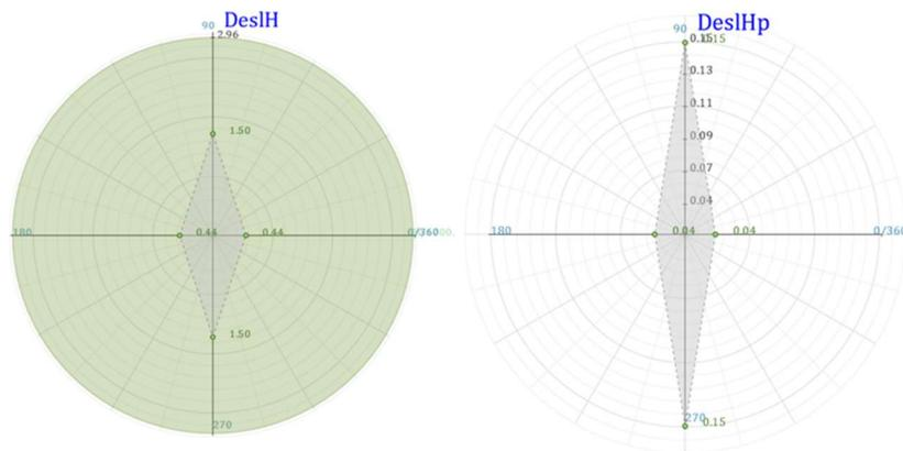
**Figura 3 - Deslocamentos horizontais absoluto (DeslH) e entre pisos (DeslHp) em cm, 30 MPa.**
