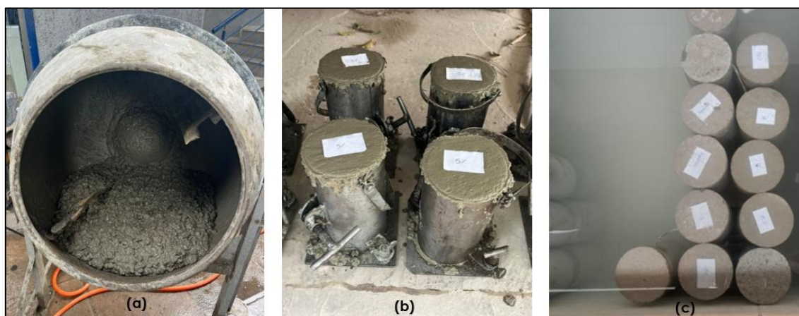
Figura 3– a. Concreto na betoneira, b. Moldagem dos corpos de prova, c. Cura úmida
