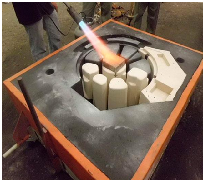
Figura 1 – Processo de fundição em areia verde
