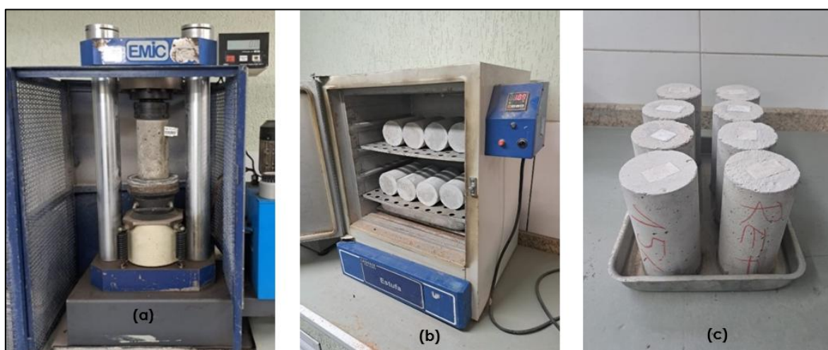
Figura 4– a. Máquina universal, b. Corpos de prova na estufa, c. Após imersos em água Fonte: autor (2024)
