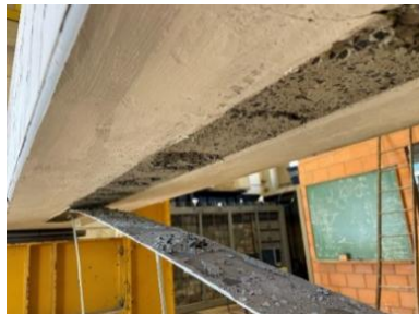
Figura 15 – Modo de ruptura experimental da VR (Pereira et al. (2024)).
