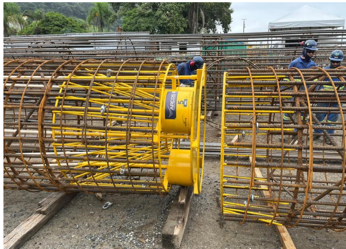
Prova de carga com célula de carga
